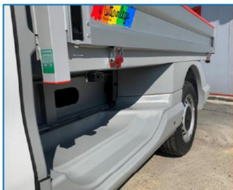
Kit de couverture plancher en ABS: cloison étanche et finitions latérales et arrière, de série.
