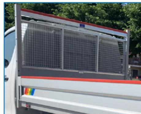
Protège-cabine grillagée en acier galvanisé avec colonnes en aluminium, standard.
